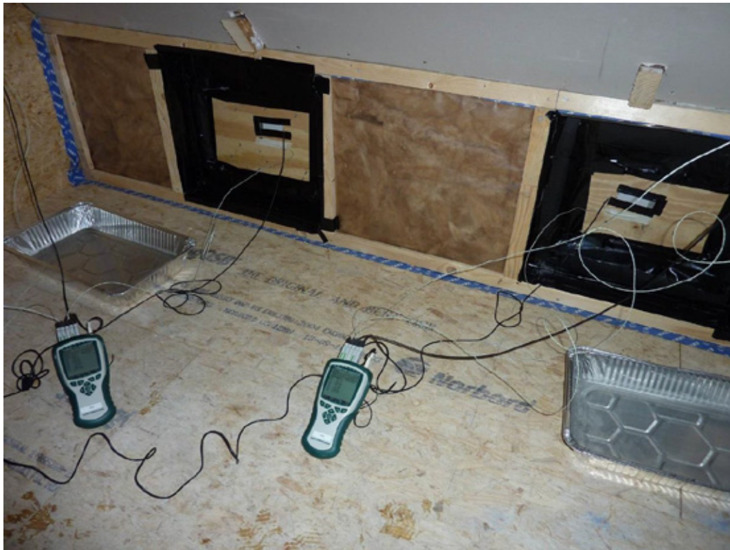
B4: Billede af prøvefelter VA og VB på vægflade (dataloggere på testhusets gulv).
