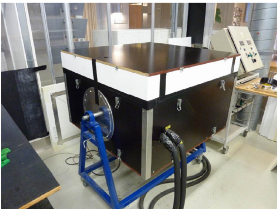
Foto 6. Prøveemne nr. 1 i målekasse, klar til måling
